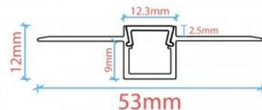
Profil pour ruban LED - encastré / sans rebord - 9x12mm - Avec diffuseur - 2 mètres
