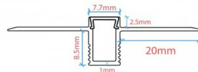
Profil pour ruban LED - encastré / sans rebord - 8x7mm - Avec diffuseur - 2 mètres
