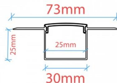
Profil pour ruban LED - encastré / sans rebord - 25x25mm - Avec diffuseur - 2 mètres
