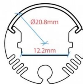
**Profil cylindrique pour ruban LED - ø 20 mm - Avec diffuseur - Surface / Suspension - 2 mètres**
