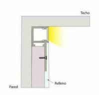
Bande LED profilée d'intégration / trimless - Single fin - 14x35mm - Avec diffuseur - 2 mètres
